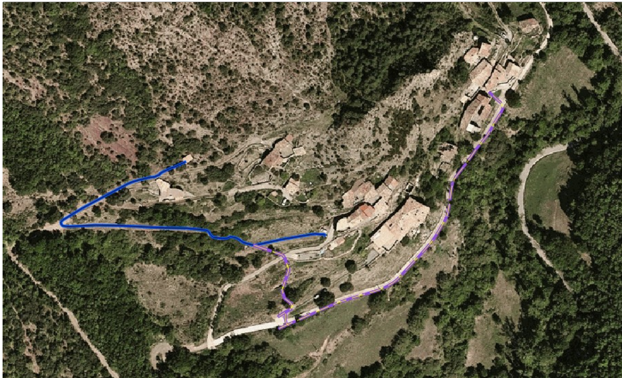
Figura 2: Proposta de xarxa de distribució d'aigua, fases I, II i III
